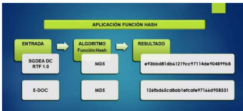
Figura 16 Ejemplo de aplicación de la función Hash
