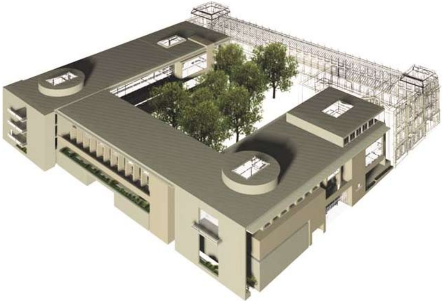
FASE CONSTRUCTIVA No. 3 . ESQUEMA DE CONSTRUCCIÓN DEL PROYECTO POR FASES CONSTRUCTIVAS-TECTUS LTDA. (2005)
